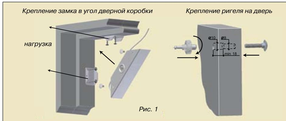
ветная часть замка – ригель – устанавливается на дверь (см. рис. 1).
