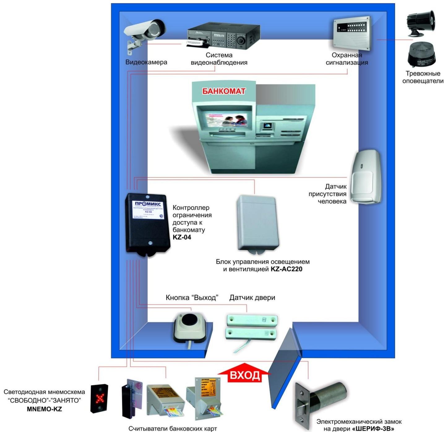
Для определения присутствия человека в помещении на дверь необходимо установить герконовый датчик, а внутри помещения - инфракрасный датчик движения.
