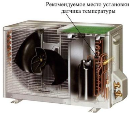
Рис.4. Место установки датчика температуры
