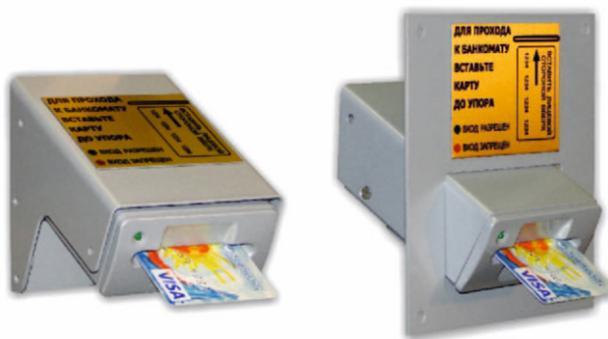
**Назначение** Предназначен для считывания идентификационной информации со второй дорожки пластиковых банковских карт с магнитной полосой и/или микропроцессора класса А, В. Считыватель снабжен двцветным светодиодом, который может использоваться для индикации состояния прохода, достоверности считанной информации или иных целей. Выполнен в металлическом антивандальном корпусе. Вариант крепления: «накладной», «врезной».
