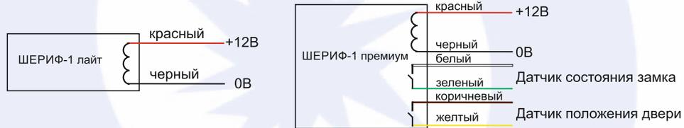
Схема подключения замка "Шериф-1 лайт" к контроллеру (на примере контроллера JSB-CL002)
