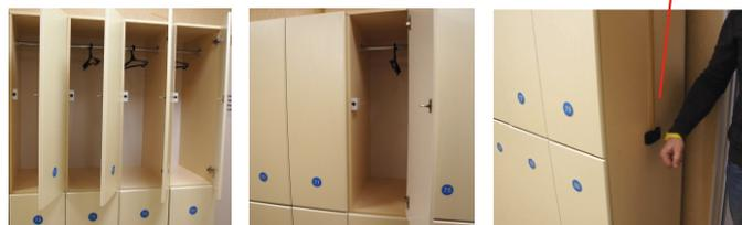
На дверях шкафов установлены электромеханические замки "ШЕРИФ-4" и датчики состояния двери, подключенные к периферийным контроллерам управления sheriff-L-z8.1. Каждая секция шкафов снабжена считывателем
