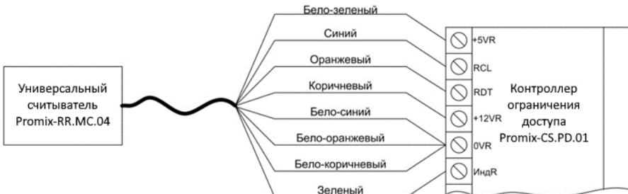
Рис.7. Подключение считывателя к контроллеру Promix-CS.PD.01
