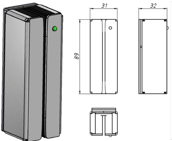
Рис.1. Габаритные и установочные размеры считывателя
