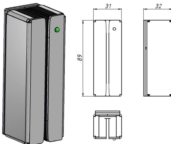
Рис.1. Габаритные и установочные размеры считывателя
