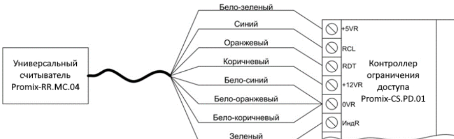
Рис.7. Подключение считывателя к контроллеру Promix-CS.PD.01
