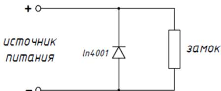
Для избежания помех, создаваемых переключением индуктивной нагрузки замка, рекомендуется подключать обратный диод, (например, диод выпрямительный In4001).
