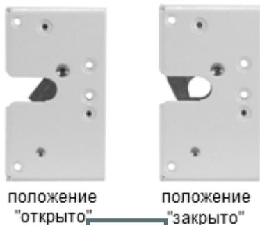
При закрытии двери ригель входит в паз замка и, преодолев усилие крюка-захвата, фиксируется, переводя крюк-захват из положения "открыто" в положение "закрыто". При подаче напряжения питания (в нормально закрытом исполнении - при снятии напряжения питания) крюк-захват в положении "закрыто" блокируется и запирает ригель.
