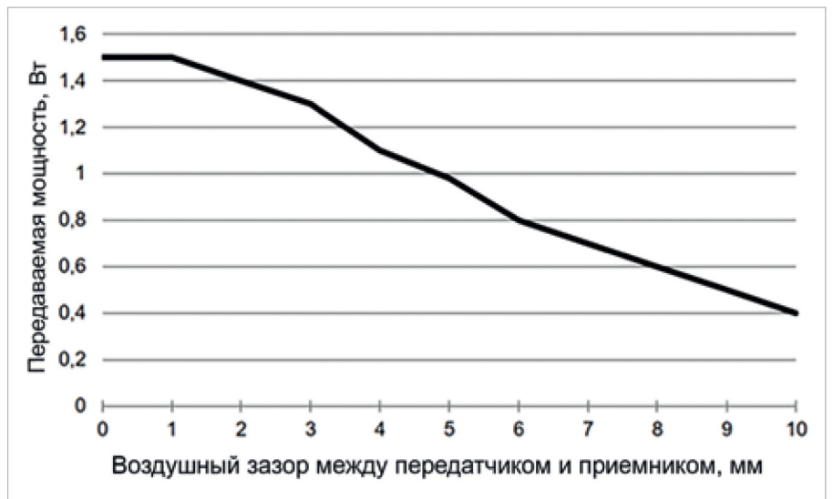
Рис. 6. Зависимость передаваемой мощности от величины зазора
