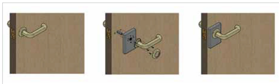
Рис. 2. Установка замка Promix-SM503 и Promix-SM504
